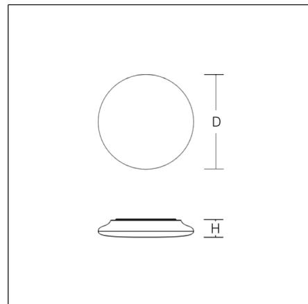
Luminaire apparent LED rond, plat et décoratif. Corps en matière synthétique (polycarbonate). Diffuseur en matière synthétique (polycarbonate) opalin. Corps et diffuseur fermement raccordés. MultiColor: Température de couleur avec élément de commutation réglable sur 3000 K (réglage usine), 4000 K et 5700 K. Adaptateur de montage rapide en métal blanc, traité époxy, avec fixation à baïonnette. Appareillage intégré.
