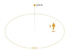
$\label{eq:model} \mbox{M\"{o}gliche Montageh\"{o}he: 2,00 m - 4,00 m} \\ \mbox{Orange: radial und tangential}$
