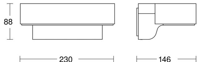
Luminaire extérieur LED à détection
