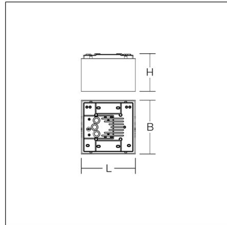
Leuchte zur Rettungswegkennzeichnung. Armatur Aluminium-Druckguss pulverbeschichtet Diffusor Kunststoff (PMMA) opal. 4 Folien zur Rettungswegkennzeichnung beigelegt (nach ISO 7010). Betriebsgeräte integriert. Einzelbatteriesystem mit automatischem Selbsttest. Durch Zubehör als Pendelleuchte montierbar.
