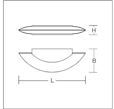
Eine in dieser Form einzigartige Wandleuchte mit elliptischem Glas. Armatur Aluminium-Druckguss lackiert. Mundgeblasenes Opalglass seidenmatt mit Glasabschlussblenden klar. Homogene und weiche Ausleuchtung. Befestigung des Leuchtenkörpers mit Senkschrauben. Horizontale und vertikale Montage möglich.
