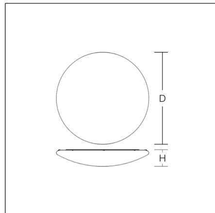
Decorativa luminaria redonda de montaje en superficie. Para iluminación de emergencia. Base de metal revestido al polvo. Difusor de material sintético opalino (PMMA) que no amarillea. Sujeción del difusor con mecanismo de cierre patentado (cierre a presión). Apto para Montaje en superficie de techos, Montaje en superficie de la pared. Equipo incluido. Sistema de emergencia autónoma con autotest.
