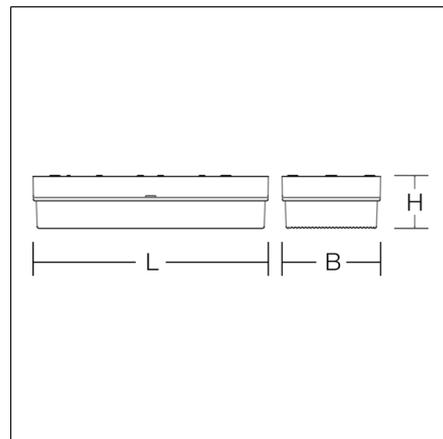
Vollkunststoffleuchte in schlagzäher Ausführung. Zur Rettungswegkennzeichnung oder Rettungswegbeleuchtung. Armatur Kunststoff (Polycarbonat). Refraktor Kunststoff (Polycarbonat) klar, prismatisch. 4 Folien zur Rettungswegkennzeichnung beigelegt. Geeignet für Wandanbau. Mit Zubehör auch als Pendelleuchte möglich. Mit Überwachungsbaustein AC-Control für LUXIFAIR Zentralbatterie-Anlagen.
