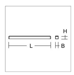
Deckenleuchte in minimalistischem Design. Gehäuse Aluminium-Strangpressprofil pulverbeschichtet. Endkappen Aluminium pulverbeschichtet. Diffusor aus vergilbungsfreiem Kunststoff (PMMA) mikroprismatisch. Geeignet für Deckenanbau, Wandanbau. Betriebsgerät extern mit Verbindungsleitung.
