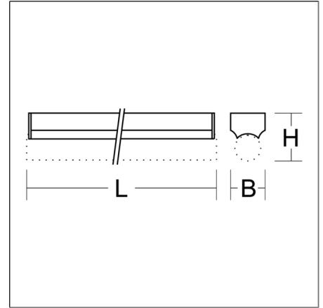
Alu-Stableuchte für Linienlampen. Armatur Aluminium-Strangpressprofil pulverbeschichtet. Endkappen Kunststoff. Spannungsfreischaltung der Lampenkontakte bei Lampenwechsel. Leuchtmittel bitte separat bestellen.
