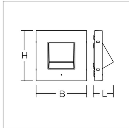
Luminaria de pared para iluminación de emergencia. Base de aluminio inyectado, revestido al polvo. Difusor de material sintético (policarbonato). Con lente para iluminación de vías de evacuación. Giratorio verticalmente. Equipo incluido. Sistema de emergencia autónoma con autotest. Luminarias con temperatura superficial limitada, conforme a la norma EN 60598-2-24. Para entornos polvorientos donde se puedan dar deposiciones de polvo conductible sobre las luminarias.
