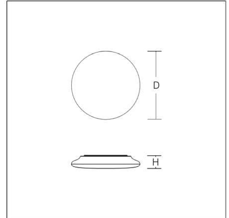
Flache dekorative runde LED-Anbauleuchte. Gehäuse Kunststoff (Polycarbonat). Diffusor Kunststoff (Polycarbonat) opal. Gehäuse und Diffusor fest verbunden. MultiColour: Farbtemperatur mit Schaltelement einstellbar auf 3000 K (Werkseinstellung), 4000 K und 5700 K. Schnellmontageadapter Stahlblech weiß pulverbeschichtet, mit Bajonettbefestigung. Betriebsgerät integriert.
