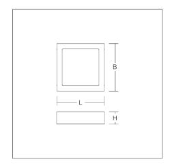
Superflaches Anbau-Downlight. Anbaugehäuse Stahlblech pulverbeschichtet. Quadratische Abdeckplatte Aluminium-Druckguss pulverbeschichtet. Lightguide und Diffusor aus vergilbungsfreiem PMMA opal matt. Geeignet für Deckenanbau, Wandanbau. Betriebsgerät integriert.
