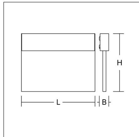
Luminaire pour la signalisation des voies d'évacuation. Corps en profilé d'aluminium extrudé, anodisé ou traité époxy. Plaque display en matière synthétique haute transparence avec pictogramme de secours simple face. Appareillage intégré. Système de batterie autonome avec auto-test automatique. Merci d'indiquer le numéro de motif du pictogramme de secours lors de la commande
