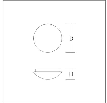
Decorativa luminaria redonda de montaje en superficie, para interiores y exteriores. Base de material sintético. Difusor de material sintético (policarbonato) opalino, resistente a golpes. Sujeción del difusor mediante sistema de muelles. Apto para Montaje en superficie de techos, Montaje en superficie de la pared. IP 43 montaje en techo, IP 44 montaje en pared.
