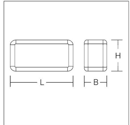
Leuchte zur Rettungswegkennzeichnung. Gehäuse Aluminium mit Eckverbindungen Kunststoff. Kunststoffscheibe opal mit Rettungszeichen einseitig. Betriebsgerät integriert. Zum Anschluss an zentrale Sicherheitsstromversorgung geeignet. Symbolnummer für Rettungszeichen bei Bestellung angeben!
