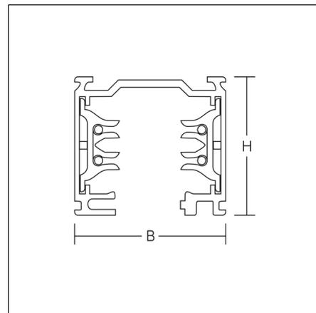
Extrudé aluminium profilé laqué, rails pouvant être raccourcis à volonté, manipulation sans risques, avec cinq alésages de fixation à 100, 990, 1990, 2990, 3870 mm.
