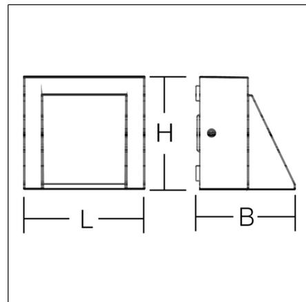
Applique. Corps en aluminium injecté traité époxy. Diffuseur en verre transparent. Diffusion lumineuse unilatérale. Appareillage intégré.
