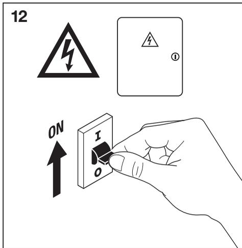
Ⓜ Netzanschluss bitte nach den länderspezifischen Errichtungsbestimmungen tätigen. Mindestabstand von brennenden Gegenständen 0,3m. Bedienungsanleitung für spätere Verwendung aufbewahren.
