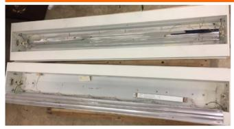
**Benötigtes Werkzeug:** Seitenschneider, Abisolierzange, verschiedene Schraubendreher Notwendige neue Drähte müssen den aktuellen Versionen der EN 50525 und EN 60598-1 entsprechen und u.a. einen Mindestquerschnitt von 0,4 mm² und die Isolierung eine Nenndicke von 0,5 mm aufweisen
