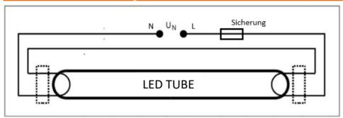
Schritt 1: Netzleitung "L" mithilfe einer der beiliegenden WAGO-Klemmen mit einer Leitung der Sicherung verbinden
