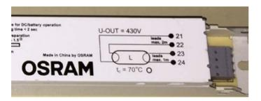
Schritt 2: zweite Leitung der Sicherung mit Leitung "21" verbinden.
