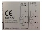
Schritt 2: zweite Leitung der Sicherung mit Leitung "1" verbinden.
