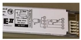
Schritt 2: zweite Leitung der Sicherung mit Leitung "1" verbinden.
