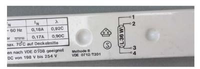
Schritt 2: zweite Leitung der Sicherung mit Leitung "1" verbinden.
