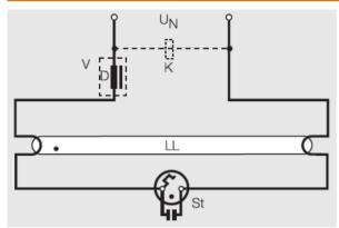
Verdrahtung am KVG Schritt für Schritt entfernen und wie beschrieben verbinden, ggf. vorhandenen Kompensationskondensator entfernen
